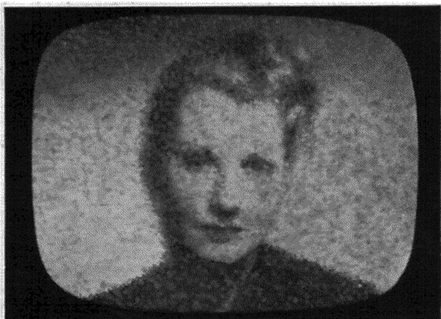
Zu schwach einfallender Sender, Antenne verbessern. Evtl. verkehrter Antennen-Anschluß („Nah“) verwendet
