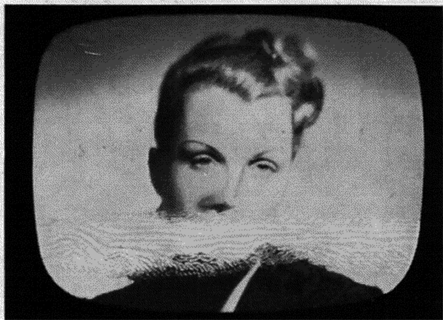
Störung durch Heilgeräte, Stördienst der Bundespost benachrichtigen
