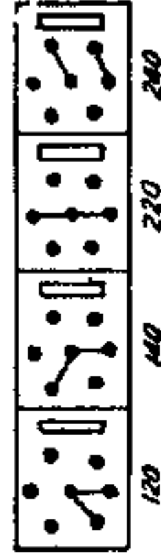
Au-dessus : Plaque de commutation de la tension du secteur avec la valve CY2. Au-dessous : Plaque de commutation avec la valve CY1.
