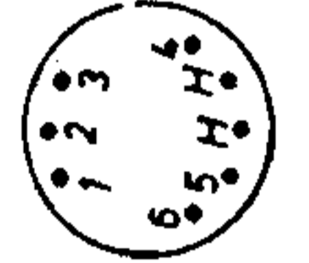
ECH42, EF41, EAF42 EM11 EL41 Sockelschaltungen
