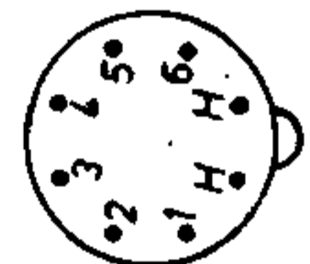
ECH42, EF41, EAF42 EM11 EL41 Sockelschaltungen
