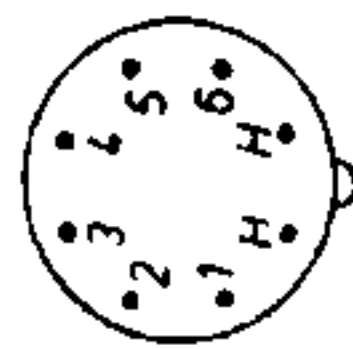
UCH 42, UAF 42, UF 41, UL 41 Sockelschaltungen
