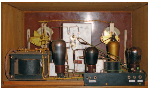
Weco bouwpakket Afgeschermd Drie voor wisselstroom. Interieur van een toestel, gereconstrueerd op basis van op een rommelmarkt gevonden restanten. De plaatsing van de onderdelen is niet conform het officiële bouwplan. Op de foto niet zichtbaar, maar de spoelenheid is de gewijzigde versie van 1930. Collectie: Radio Amateur Museum, Reusel.
