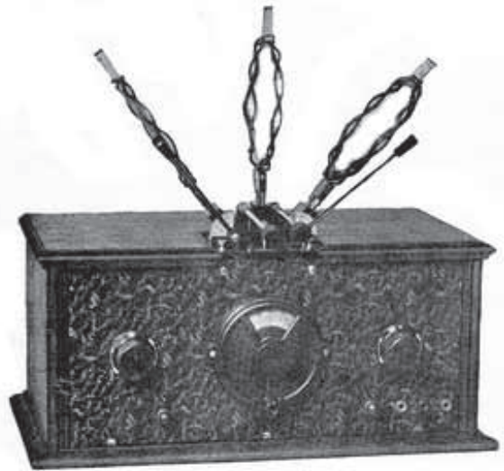
Weco-Kortegolfontvanger, het eerste Weco-radiotoestel, uit 1927. Het is een accutoestel met de lampen A415 (of A409), A409 en B406. Verkoopprijs f 110. (Biedermann's Maandblad, juli 1927).
