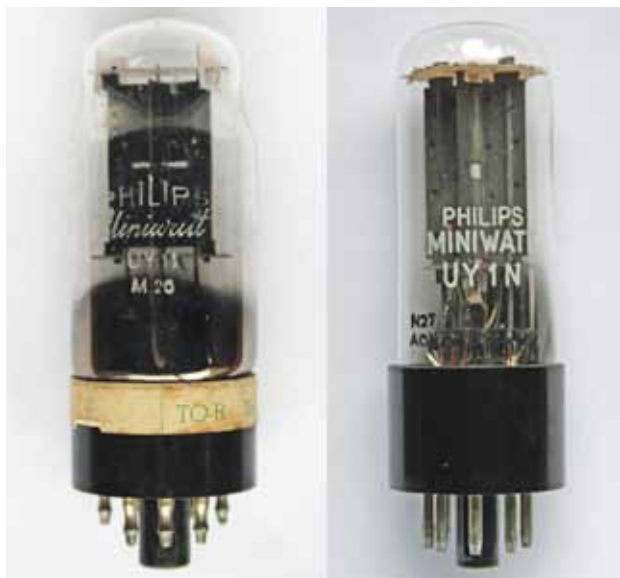
Het personeel van de radiolampenfabriek maakte eerst de gelijkrichtbuizen UY11 en UY1N om het handwerk aan te leren.
