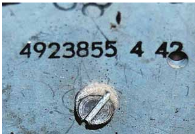
Artikelcode en datumstempel op de luidspreker van een Philips 656A-19. (Collectie en foto Anders Söderström).
