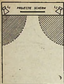
Fig. 7. Bioscoopzaal met twee luid- sprekers voor stereofonische geluidsweergave.
