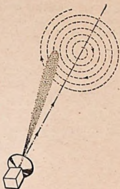
Fig. 1. Spiraal-afasting van de ruimte in het front van een nachtjager. De rechte getrokken lijn geeft de vliegrichting aan. De gestippelde bundel is de door den parabolischen reflector uitgezonden straling. De kegel, waarbinnen de aftasting plaats heeft, had een tophoek van ongeveer 90 graden.
