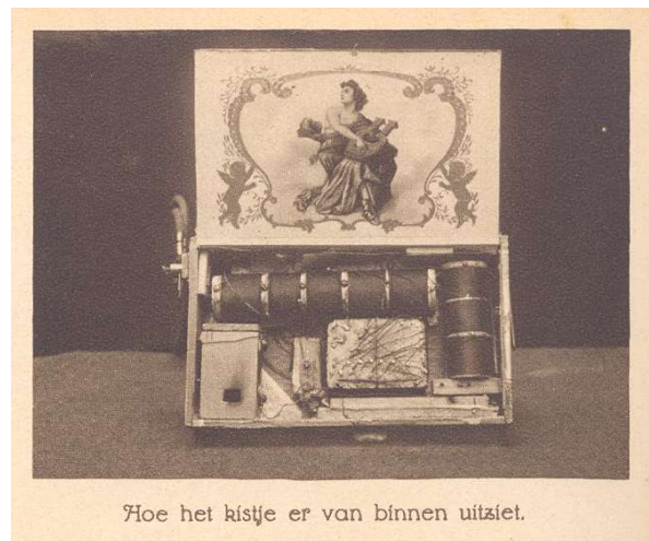
Een volledig draadloos ontvangtoestel in een sigarenkistje.
